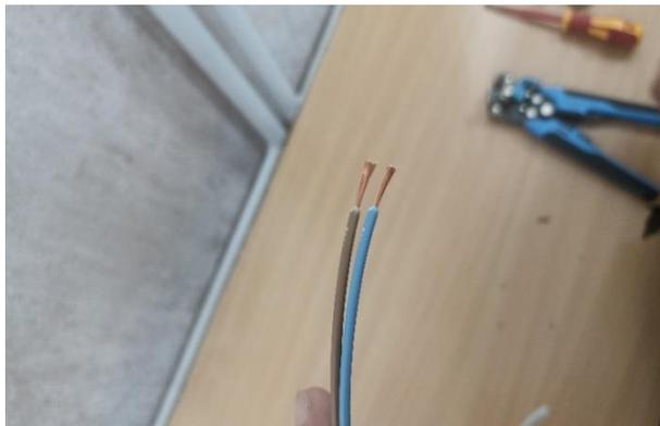
Произвести оконцевание жил проводов НШВИ (наконечник штыревой втулочный изолированный), с помощью пресс-клещей.
